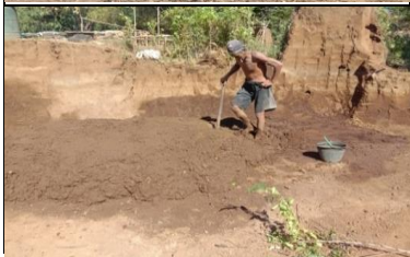
Dilanjutkan oleh proses pengadonan dengan cara menginjak nginjak tanah yang sudah ditaburi gabah (foto diambil di lokasi ke-dua)
